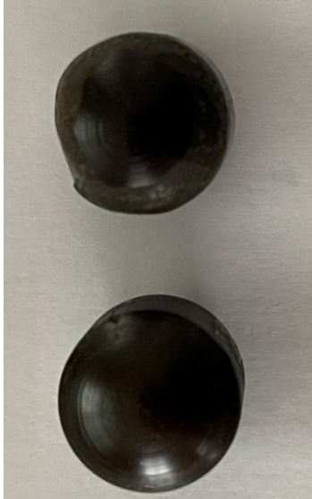
Ventilkopf oben defekt Ventilkopf unten OK
