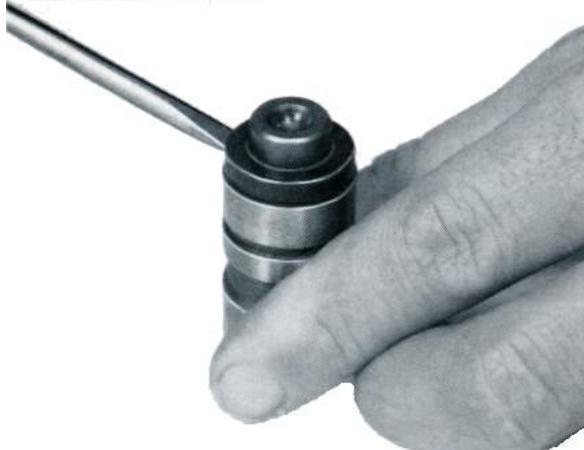
Stößelpanne, Kolben und Feder aus dem Stößelgehäuse herausnehmen.
